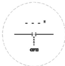
Quando il voltaggio è troppo basso, l'icona del livello batteria evidenzierà la necessità di sostituirla. Seguire le figure per la sostituzione.
